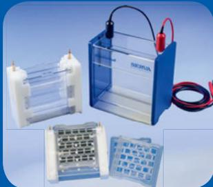
Elektrophoresekammer mit optionalem Tankblottingmodul
