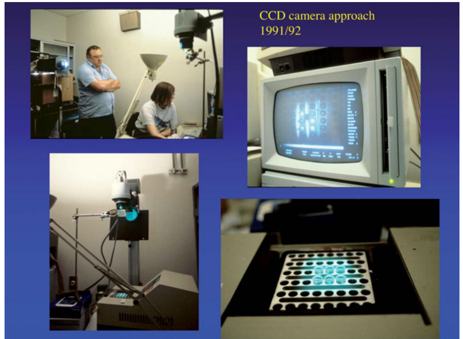
In ihren ersten qPCR-Versuchen beobachteten Russ Higuchi und seine Kollegen von der Firma Cetus die Zunahme des interkalierenden Farbstoffs noch mit einer CCD-Kamera.
