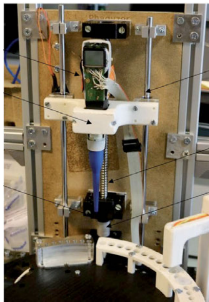
Sieht ziemlich wild aus, funktioniert aber: Gehackte elektronische Pipette, die zum Pipettierkopf für eine selbstgebaute Workstation umgestaltet wurde.
