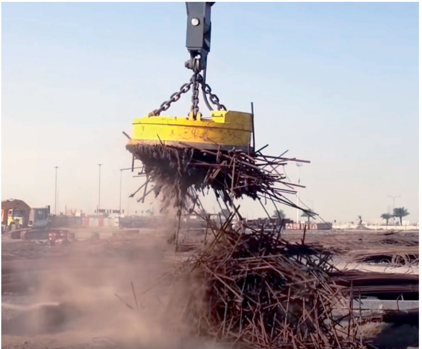
Der Magnet ist auf dem Schrottplatz zwar eine Nummer größer. Das Prinzip für die magnetische Trennung von Eisen und anderem Schrott ist aber exakt das gleiche wie bei der Separation von Zellen mit der magnetisch aktivierten Zellsolierung.
