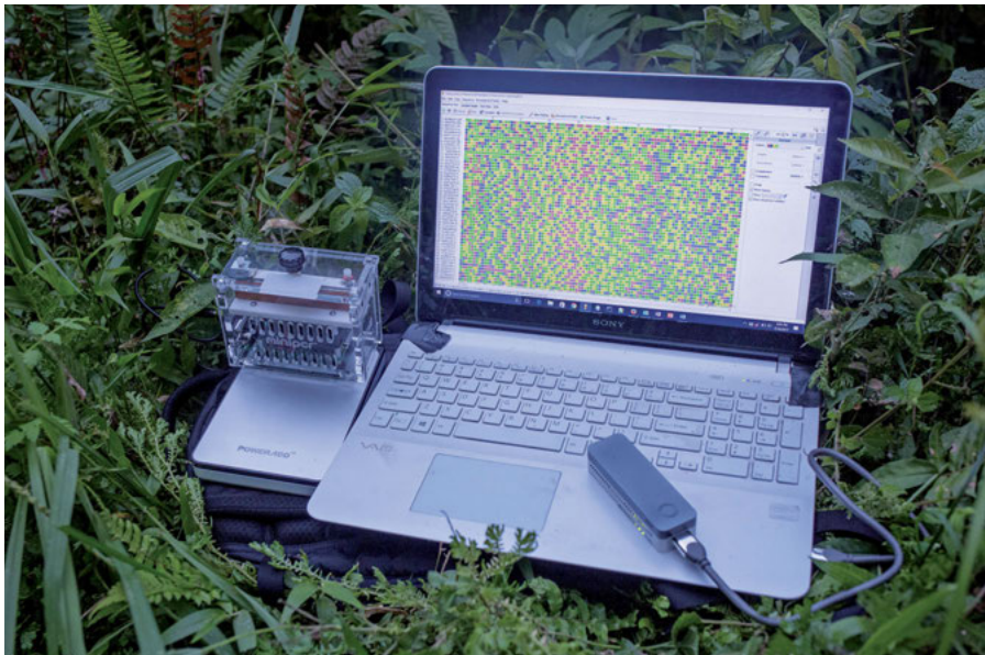
Ausgerüstet mit transportablem Thermocycler, Sequenzierer und Laptop können Biologen ihre Proben selbst im entlegensten Dschungelcamp direkt vor Ort sequenzieren und auswerten.
