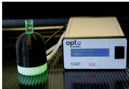
*Das Probenröhrchen mit den Zellen wird in dem Beleuchtungsmodul platziert. Das Ganze ist mit einer Steuereinheit verbunden, die für die Kühlung der Proben sowie eine dosierte Beleuchtung sorgt. Für die Analyse der Zellen wird das Modul in die Probenaufnahme eines Durchflusszytometers eingebunden.*
