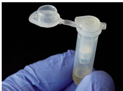
*Zusammengesetztes Spin-Säulchen mit Filterpapier-Einsatz.*
