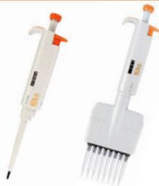
Das Volumen der Pipette kann einfach über ein Drehrad am Pipettierknopf eingestellt und über das Display abgelesen werden. Mit dem Abwerfer lassen sich die benutzten Pipettenspitzen ganz einfach entfernen. Die Sunlab® Mikroliterpipette ist entsprechend der Norm DIN EN ISO 8655 kalibriert.
