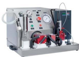
**Vorteile:** Durch den Einsatz hochwertiger Schnellverschluss-Kupplungen aus Edelstahl ist der Wechsel zwischen Probengefäß und Spülkopf schnell erledigt. Reinigung und Desinfektion dauern höchstens fünf Minuten.
